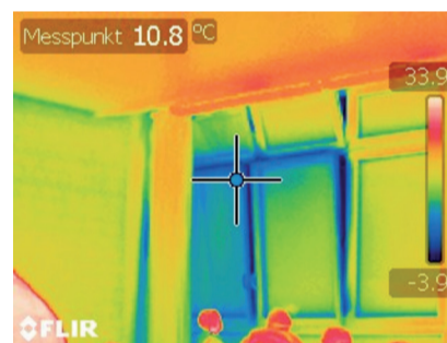
Abb. 5: Infrarotaufnahmen eines ungedämmten Schulgebäudes des Ferdinand-Porsche-Gymnasiums Zuffenhausen. Links: Aufnahme von innen; rechts: von außen. In Rot sind Bereiche mit hoher Temperatur zu sehen, in Blau kalte Bereiche. Auf beiden Fotos sieht man deutlich Unterschiede zwischen nicht gekippten und gekippten Fenstern. In der Außenaufnahme zeichnen sich die Heizkörper unterhalb der Fenster deutlich ab.
